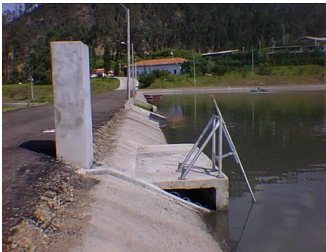
Sensores permanentes de campo para medición de oxígeno disuelto y temperatura
