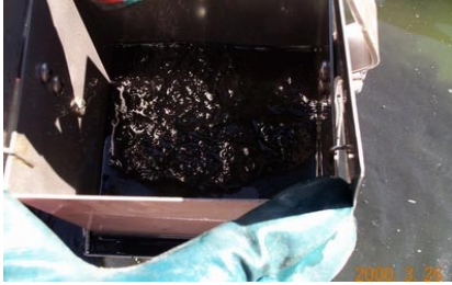
Características de lodo depositado en el fondo de lagunas
