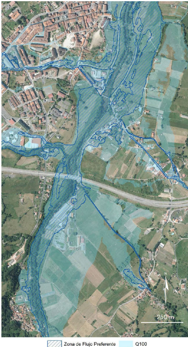
Figura 6. Riesgo de inundación fluvial: extensión de la Zona de Flujo Preferente y de la inundación de 100 años.
