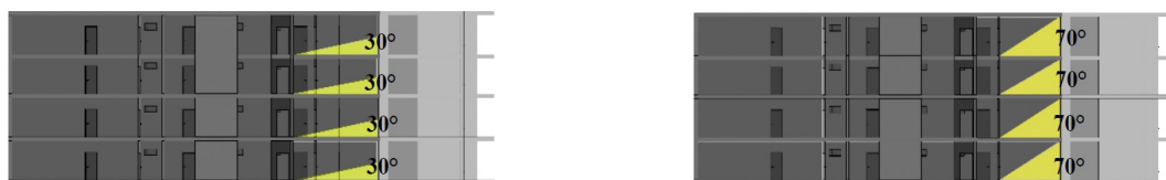
Figura 20. Imagen a la izquierda corresponde al Zoom del Corte en Solsticio de Invierno , Imagen de la derecha corresponde al Zoom Corte en Solsticio de Verano .
