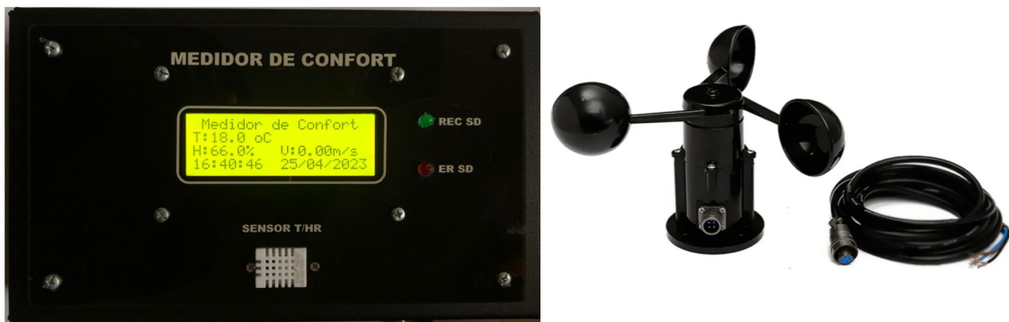
Figura 2. Instrumentos utilizados en el estudio Nota. a) Sensor de temperatura y humedad. b) Anemómetro.
