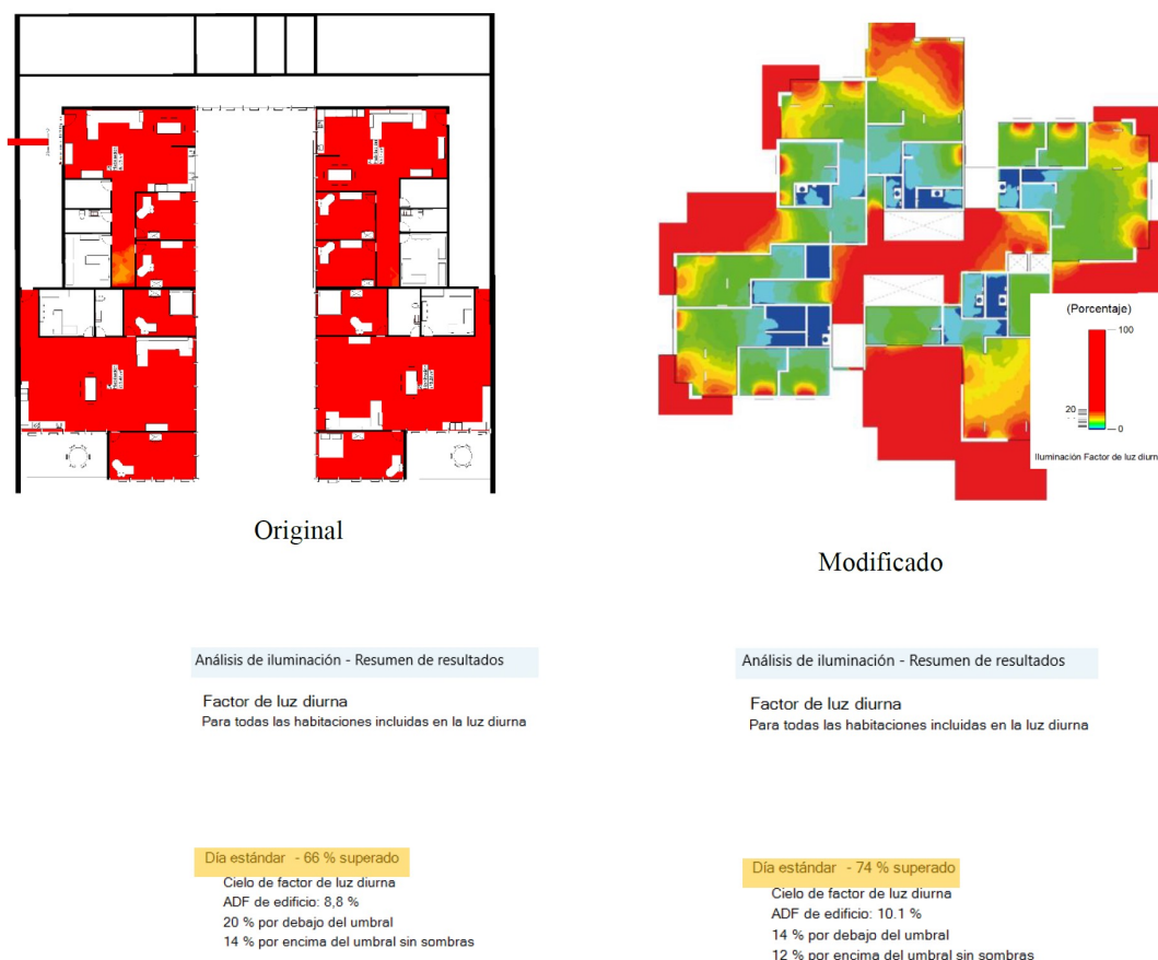
Figura 16. Análisis Factor de Luz Diurna (ADF) / Planta Tipo 2
